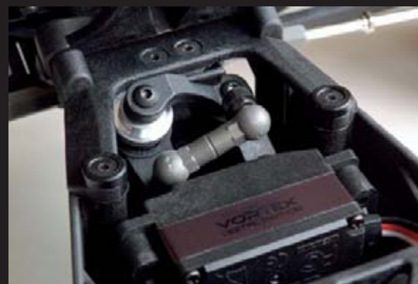
Kompakte Bauweise: Im Bereich des Servohorns und der innenliegenden Lenkhebel geht es sehr beengt zu. Die korrekte Einstellung der Lenkausschläge erfordert etwas Geduld und Feingefühl
