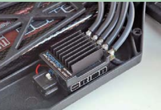
Das geräumige Chassis nimmt auch moderne Brushless-Regler – wie den feinfühligsten und leistungsstärksten Team Orion Vortex Race Spec – problemlos auf
