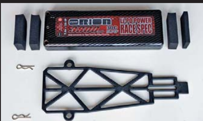
Mit Hilfe von vier Moosgummi-Blöcken lässt sich der Akku zur Gewichtsverteilung in einem weiten Bereich verschieben. Die filigrane Akkustrebe hielt im Test allen Belastungen stand
