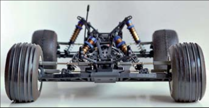
Die Vorderachse weist relativ schräg angeordnete Stoßdämpfer auf und verfügt über zahlreiche Einstellmöglichkeiten
