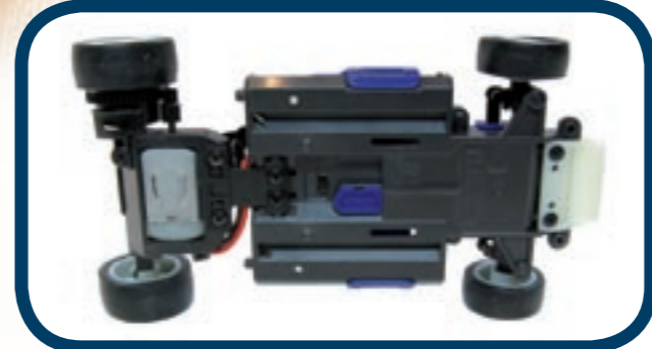
Eine Änderung ist der offene Motorhalter. So bekommt der Motor noch bessere Kühlung
