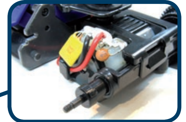
Der flach liegende Motor mit diversen Entstörkondensatoren. Wie gewohnt sind im kompletten Auto Kunststofflager verbaut
