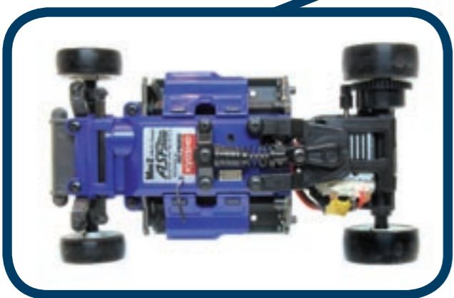
Neu ist der Pairing-Button, mit dem man das Auto an die Fernsteuerung binden, sowie der I.C.S.-Anschluss, über den man mit einem speziellen Kabel und einer Software (beides nicht im Lieferumfang) verschiedene Einstellungen am PC vornehmen kann
