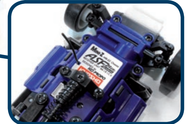
Auf der zentralen Abdeckung weist das neue Label auf die innovative 2,4-Gigahertz-Technik hin. Das kleine Kabel links daneben ist die Antenne, die im Fahrbetrieb unter der Karo verschwindet
