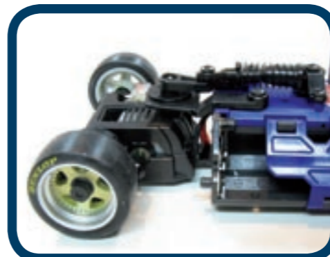
Das Heck mit neu gestaltetem Motorhalter und dem Reibungsdämpfer mit Zentralfederbein. Das komplette Dämpfersystem ist sehr flach gehalten und passt so ohne Probleme unter die Karosserie
