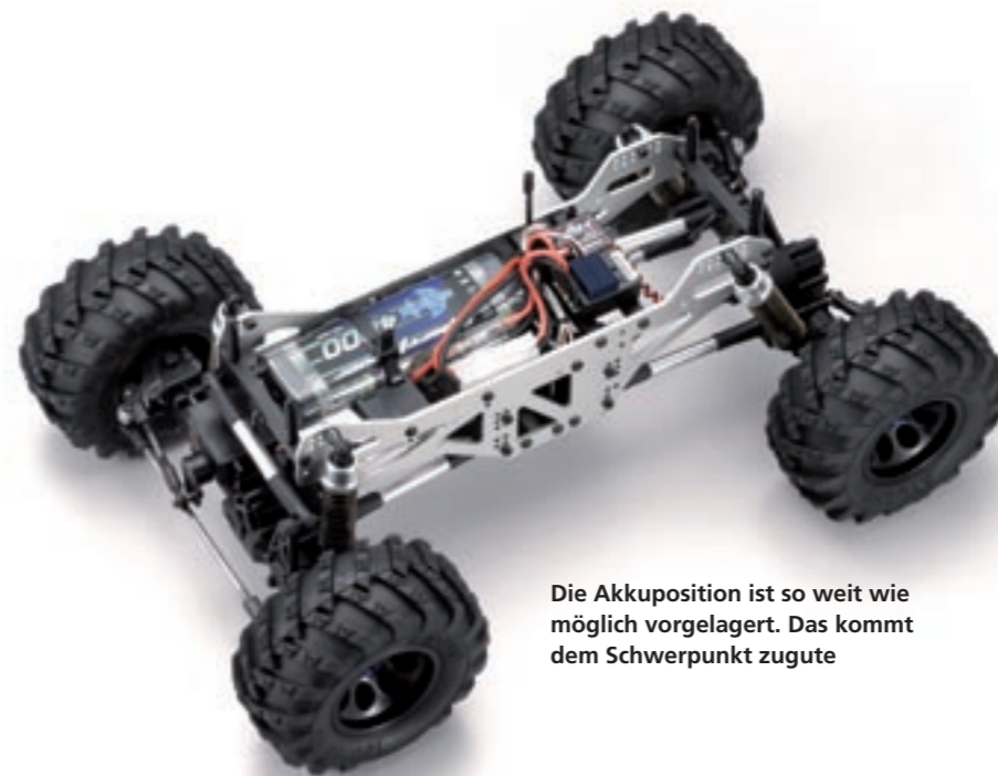
Auf der Vorderachse ist kaum noch Platz. Das Lenkservo sitzt neben Diff und Panhard-Bar-Halterung. Durch diese Aufhängung werden bloß zwei untere Links benötigt
