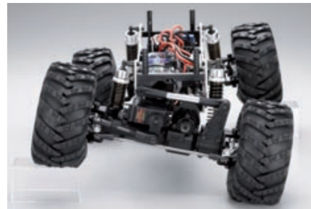
Die Panhard-Bar funktioniert einwandfrei. Die Verschränkung der Achsen ist sehr gut
