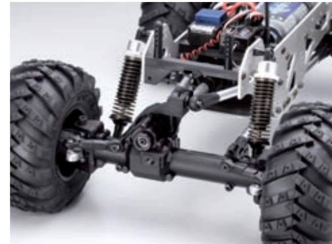
Die Hinterachse ist mit vier Links aufgehängt und verfügt über ein selbstsperrendes Schnecken-Getriebe
