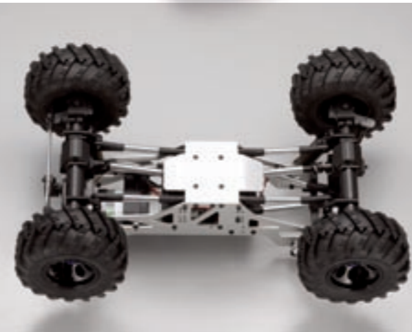
Die abgewinkelte Skidplate aus Aluminium schützt das Getriebe und die Kardanwellen
