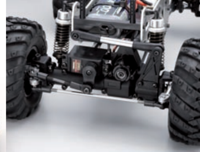
Auf der Vorderachse ist kaum noch Platz. Das Lenkservo sitzt neben Diff und Panhard-Bar-Halterung. Durch diese Aufhängung werden bloß zwei untere Links benötigt
