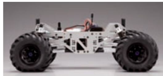
Auf den ersten Blick wirkt der Chassisaufbau klassenüblich. Alu-Rahmen und Links sind alte Bekannte
