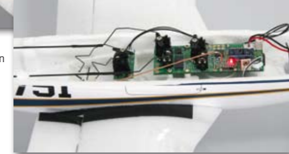
Das Querruderservo ist separat montiert. Es hat genügend Power um die Querruder in Position zu bringen
