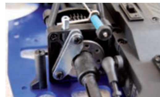
Im FW-06 ist eine zentrale Bremsscheibe aus Stahl verbaut, die das Modell auch bei Vollgas sicher zum Stehen bringt
