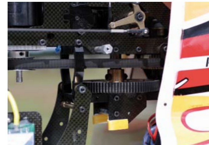
Weitgehend original belassen wurde das robuste und leise laufende Hauptgetriebe des Caliber 90, bei dem die erste Stufe mit einem Zahnriemen ausgerüstet ist
