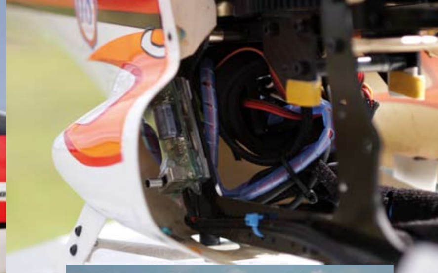
Regulator und Schalter von Helitron für die Empfängerstromversorgung
